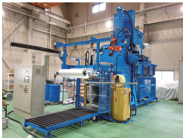
写真1 環境機械の例 袋掛け装置付容リプラ圧縮梱包機 容器包装プラスチックを圧縮し、飛散なきようにビニール袋を掛けPPバンドで結束し1m角のペール（圧縮塊）を作る装置
