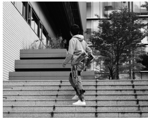
図2 博士論文研究で開発した外骨格型アシスト装置
