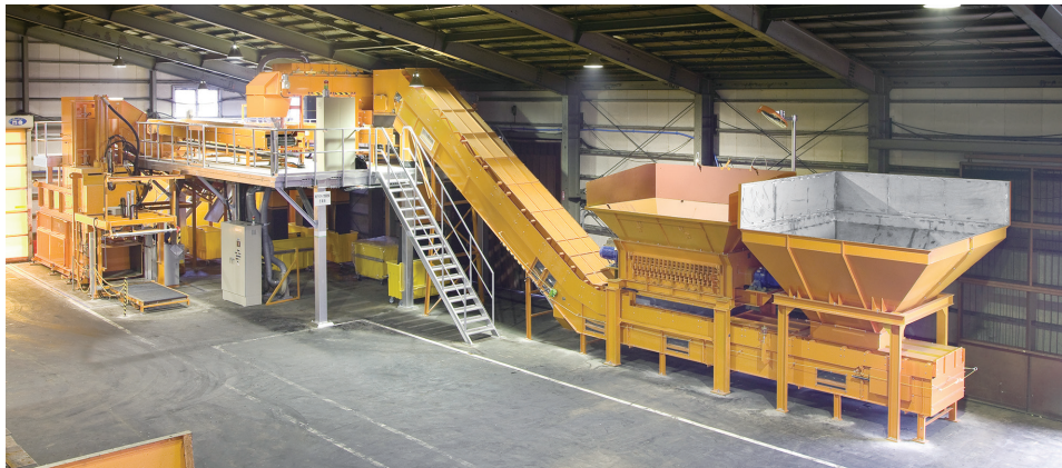
写真3 リサイクルセンターの例（右からホッパ、破袋機、磁選機付コンベヤ、風力選別機、選別コンベヤ、圧縮梱包機）
