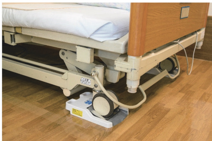
ベッド脚下に設置したセンサ
